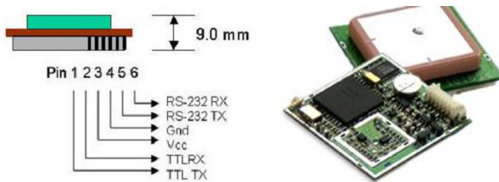
Obr. 22 Prevedenie a popis zapojenia vývodov GPS modulu PBM-248 od výrobcu POLSTAR
