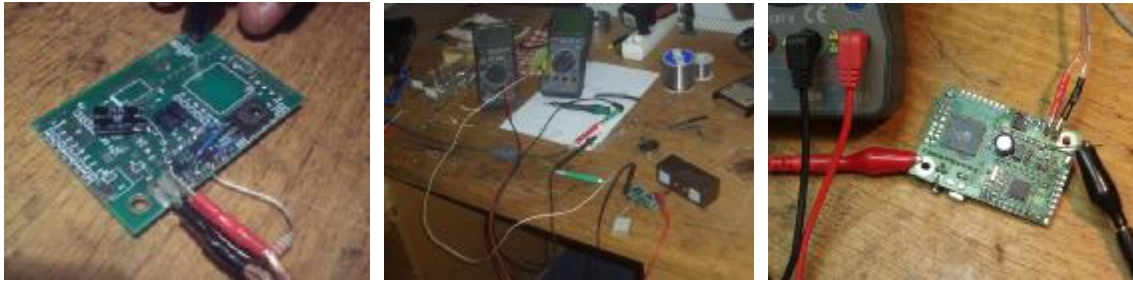
Obr. 28 Fotografie zariadenia pri testovaní správnej funkcie napájacieho zdroja (na 12 až 24V)
